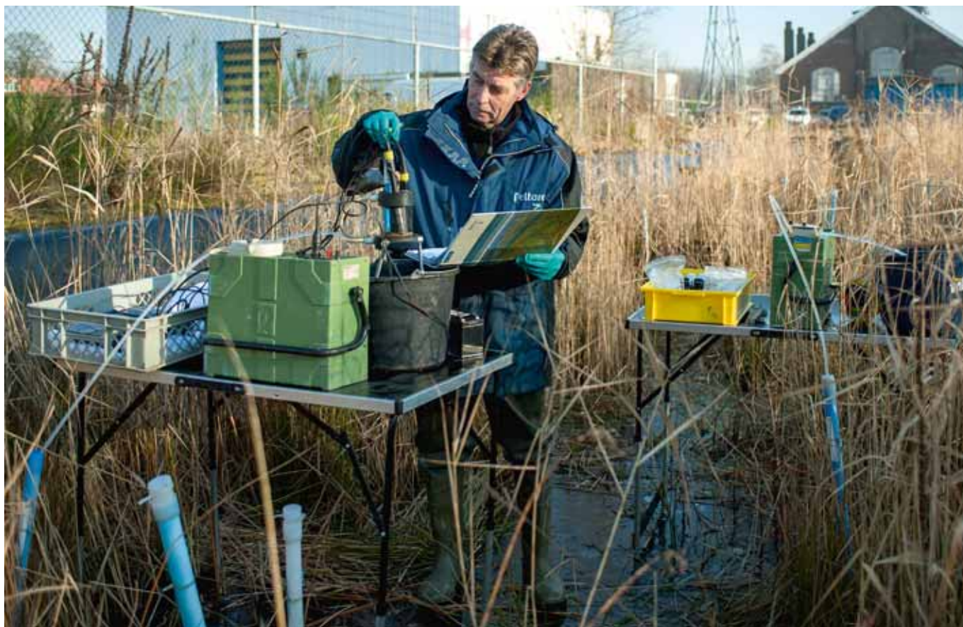
FIGUUR 2: DELTARESMEDEWERKER ANDRÉ CINJEE DOET METINGEN IN EEN BEVROREN RIETVELD; OP DE ACHTERGROND EEN WINDMOLEN WAARMEE VERONTREINIGD GRONDWATER WORDT OPGEPOMPT. EEN HELOFYTENFILTER KAN OOK IN DE WINTER VERGRIJSD GRONDWATER ZUIVEREN. FOTO: DELTARES/WELMOED JILDERDA.
