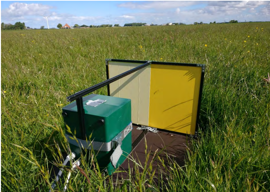
Figuur 3.26: De insectencamera van EIS kenniscentrum. In het groene kastje zit de camera die iedere 10 seconden een foto maakt van het gele scherm. De linkerkant van het gele scherm was afgeplakt met gele UV-tape voor een test.
